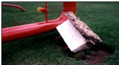
(2) Na mesma refinaria, numa curva vertical o movimento brusco gerado pelo golpe arrancou um bloco de concreto de aproximadamente 4 toneladas como se fosse uma rolha.
