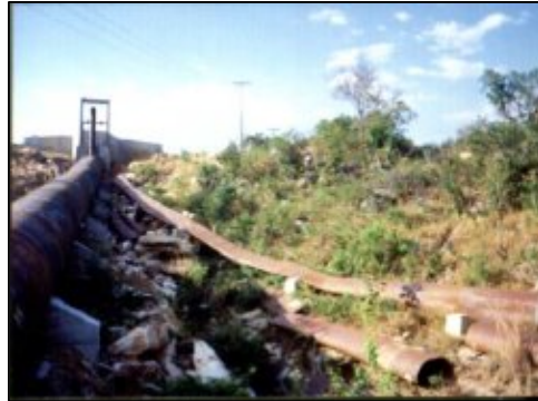
(2) Em Barreiras / BA uma adutora colapsou pela pressão negativa desenvolvida com a parada da bomba
